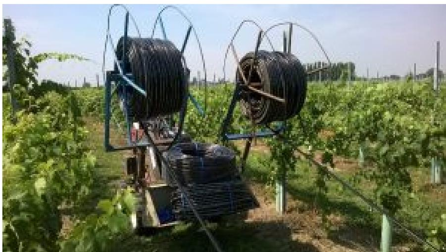
Oggi per la realizzazione delle linee irrigue sul filare, dette linee piovane o linee secondarie, si utilizzano quasi esclusivamente le cosiddette ali gocciolanti integrali, vale a dire dei tubi all'interno dei quali sono già installati i gocciolatori. In questo modo l'installazione dell'impianto è estremamente semplificata ed economica e il gocciolatore risulta più protetto e al sicuro da urti accidentali.
