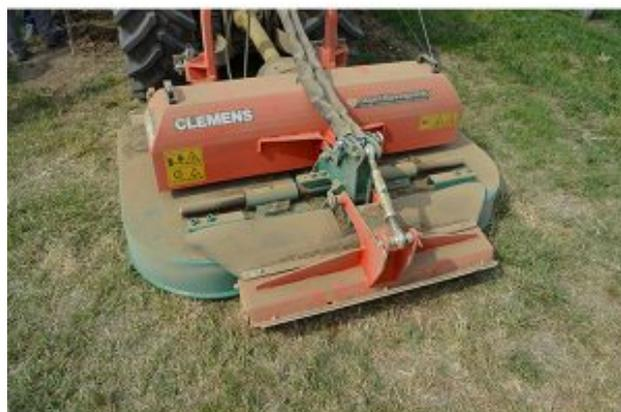
**Fig. 2** Trinciatrice a lame orizzontali.
