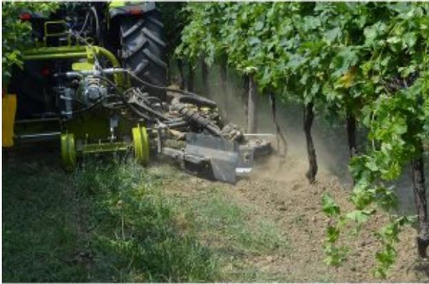
**Fig. 3** Lavorazione della fila con macchina interceppo - in questo caso erpice rotante.
