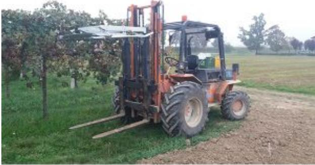
**Fig. 9** Muletto semovente per la movimentazione dei bancali o dei bins.
