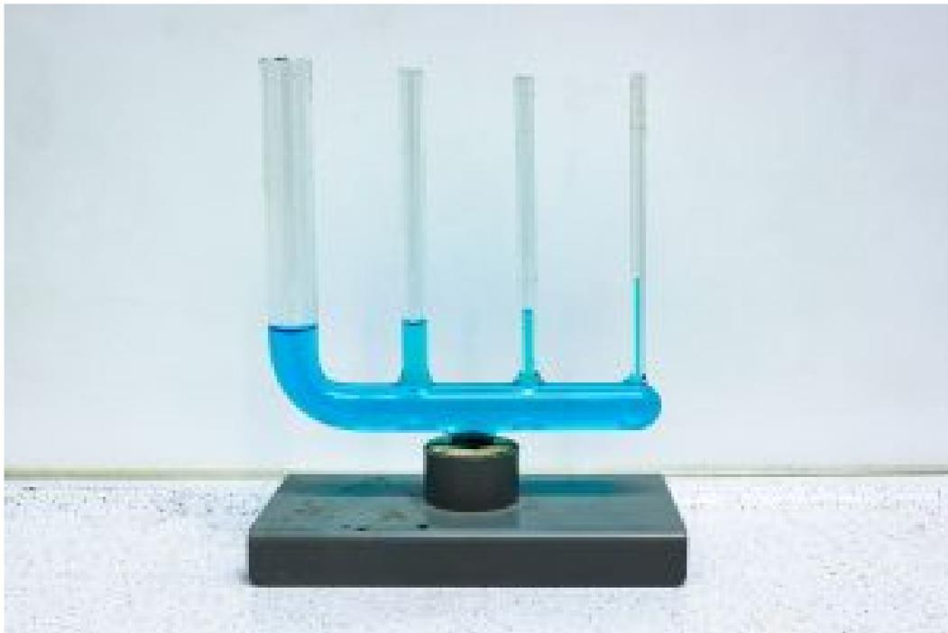
*Figura 6, 7: Principio di capillarità e imbibizione da risalita*
