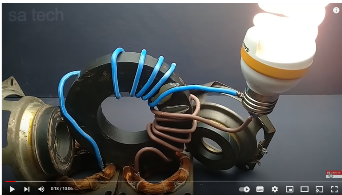
Figura 1 Pseudo produzione di energia con magneti fissi, che potrebbe funzionare solo con un generatore di campi magnetici variabili nascosto, in grado di indurre una corrente nelle bobine poste in basso.
