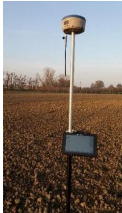
2. Ricevitore GPS e tablet per rilievo.
